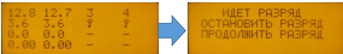
Для вызова меню прекращения испытания нажмите кнопку «ОК», кнопками «1» «3» выберите: **ОСТАНОВИТЬ РАЗРЯД** – нажмите «ОК», чтобы остановить разряд и перейти в отчет испытания. **ПРОДОЛЖИТЬ РАЗРЯД** – нажмите «ОК», чтобы не прерывать разряд и вернуться к мониторингу испытания.
