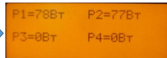
Во время испытания разряда нажмите кнопку **«1»** для просмотра мощности разряда в ваттах.
