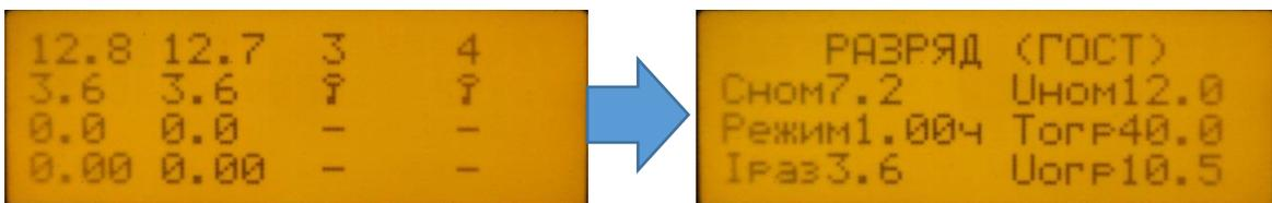
Во время испытания разряда нажмите кнопку «4» для отображения заданных параметров, запущенного испытания на разряд.
